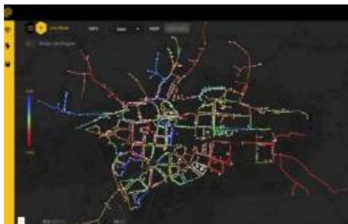
Foto de un gemelo digital en tiempo real para el análisis de flujos de carga en la red eléctrica de distribución.
